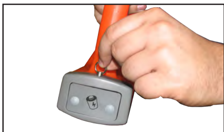
а) Выдвинуть фиксатор освободить батарейный отсек
